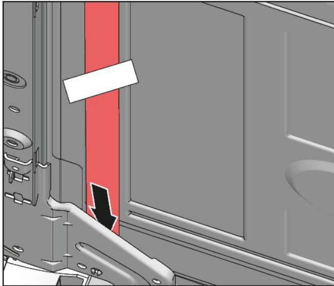
Bilde 3: Flat kabel
