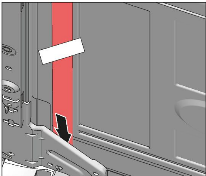
Joonis 3: Lame kaabel
