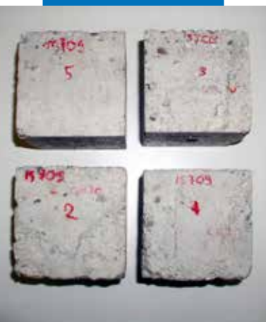
Egenskaper efter frys-cykler för prov som behandlats med Planiseal WR 90 Gel
