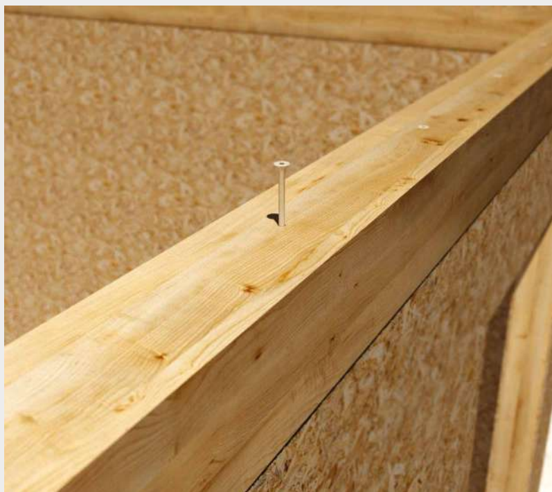
^ Fastsättning av stödbalk vid en ramstruktur.
